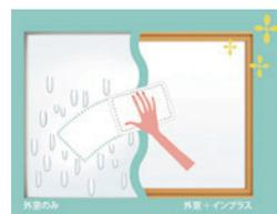
既存の窓と、内窓として取付けたインプラス、さらにその間に生まれる新しい空気層が室外と室内をしっかりと隔てる構造に。大きな断熱効果で外気温の影響を受けにくくし、結露の発生を抑えます。
